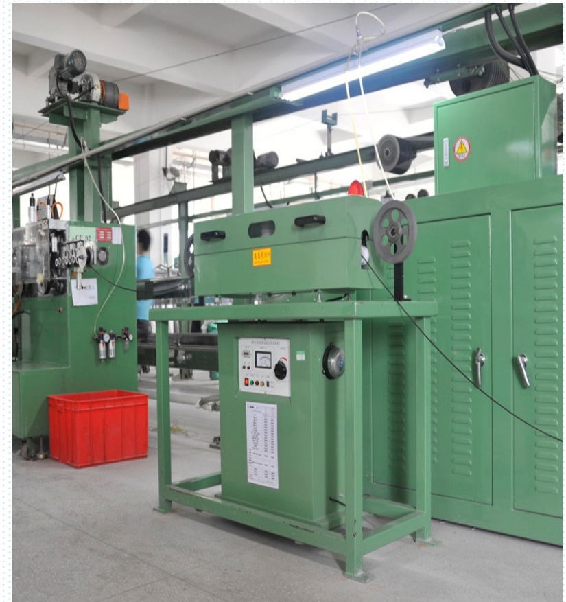
Cable Extrusion Area (9 Extrusion Machines) 電線押出車間 (9台線材押出機器)
