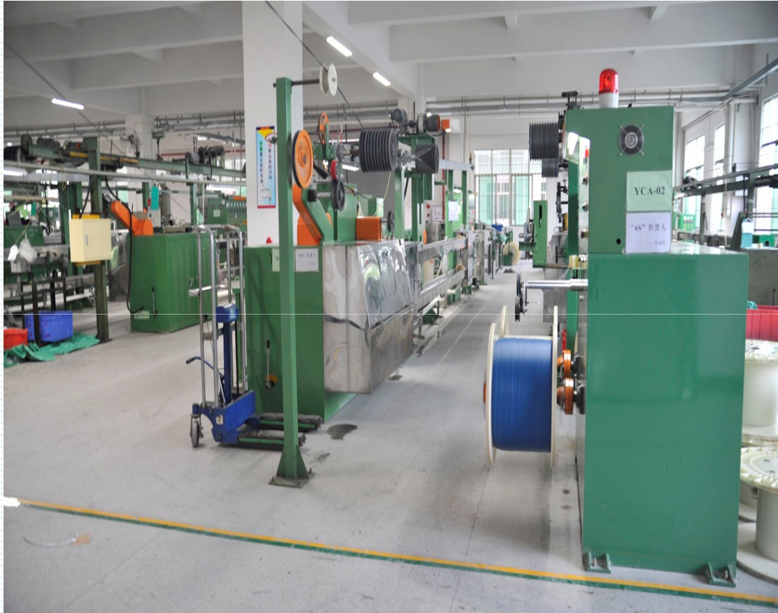
Cable Extrusion Area (9 Extrusion Machines) 電線押出車間 (9台線材押出機器)
